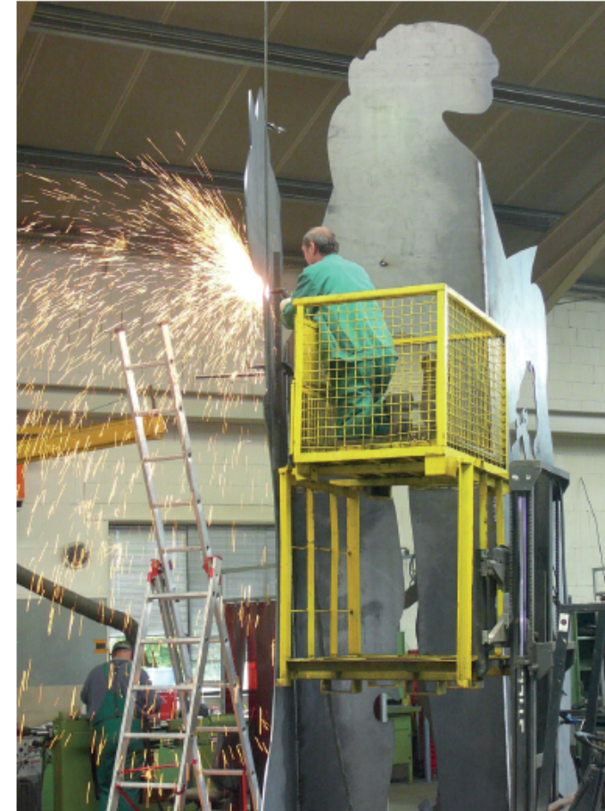
Alexander Dubs von der Firma Thiel Fördertechnik schweißt die Einzelteile der Stahlplastik zusammen.
